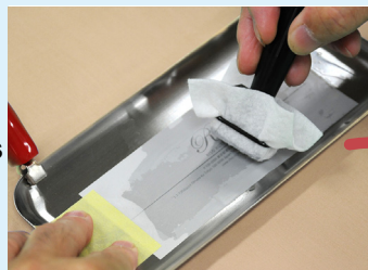
Menandai permukaan besi menggunakan Screen Sablon dari Goccopro 100
